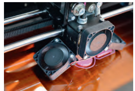
Bild 3: Nach ein bis zwei Stunden ist das Objekt bereit für den Druck: Schicht für Schicht wird es bei 215 Grad aus dem Material PLA aufgebaut.
