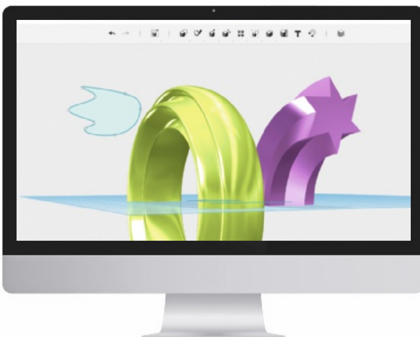
So entsteht die Gussform (Abb. 1 bis 3). Abb 1: Eine 2-D-Form wird mit dem «revolve»-Werkzeug in ein räumliches Objekt rotiert. Fotos: zVg.
